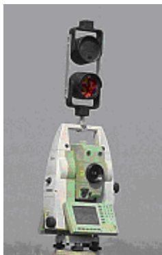
图 4.4.2 全站仪+高、低棱镜的安装
